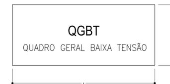
PLACA DE ACRÍLICO PANTOGRAFADA
