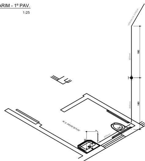
ISOMÉTRICO BANHEIRO DEF. FÍSICO - 1º PAV.
