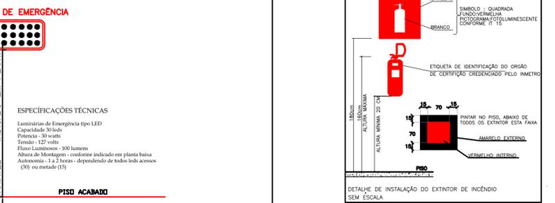
**ILUMINAÇÃO DE EMERGÊNCIA - NBR 10898:1999**
